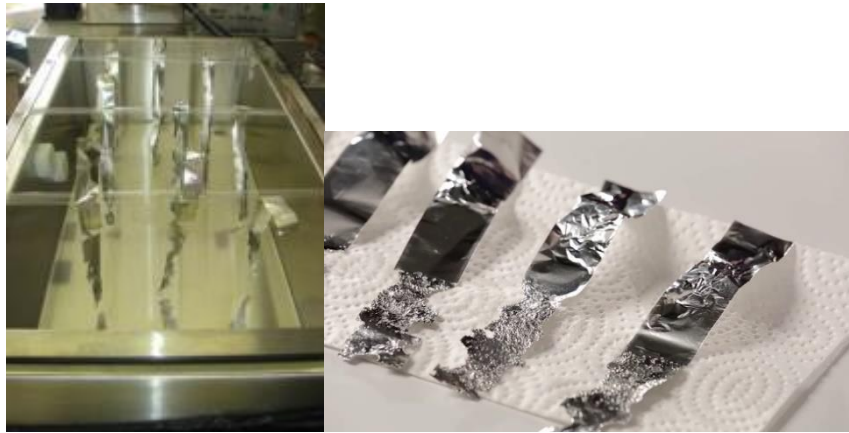
Schema 5: Visualisatie van de perforatie van aluminiumstrips met ultrasone golven
